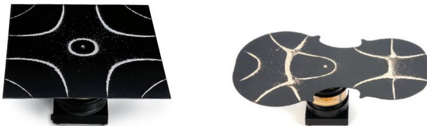
圖 25 二維克拉尼共振實驗裝置圖。
