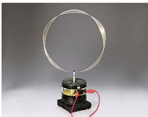
圖12 金屬環圓共振實驗架設圖，圖中並顯示具有五個節點的典型駐波結果。
